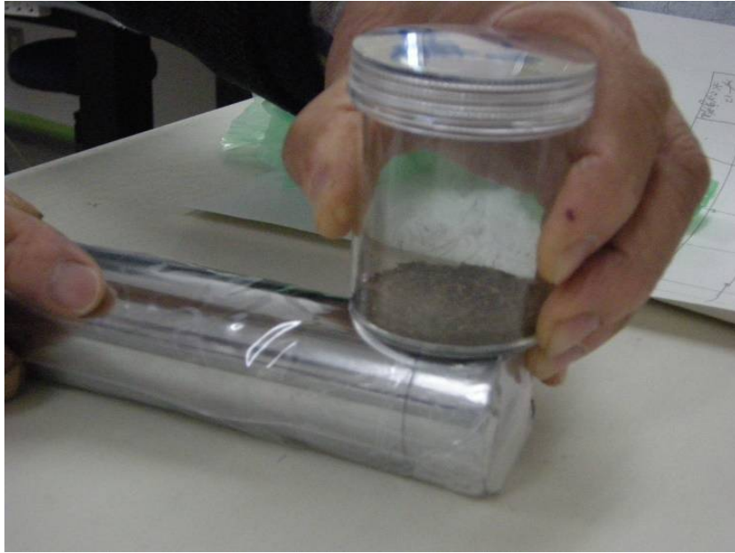
写真9 NaIシンチレータによるU8型容器の線量率測定
