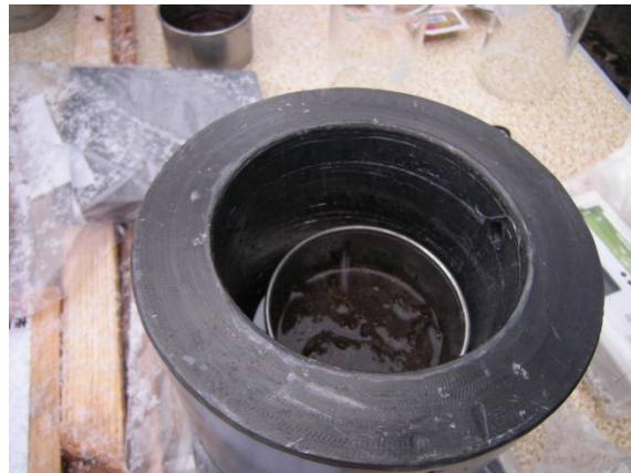
電解水 A の遮蔽容器内線量率測定（上蓋は外して撮影）
