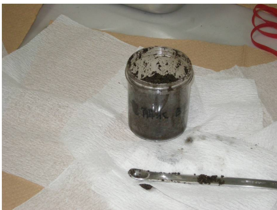
写真2 U8 型容器内土壌試料の手動攪拌 (1月15日検査開発株式会社内)
